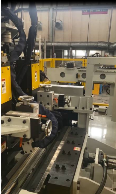
Exhaust pipe UO forming/ double TIG welding machine 排氣管UO成型/雙槍TIG焊接機
