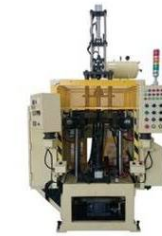
Gas Filling & Pre-Caulking M/C 充氣 & 預彎機
