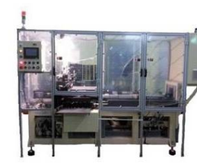
Tube Dust Cleaning & Resizing M/C 管清洗 & 擴縮管機
