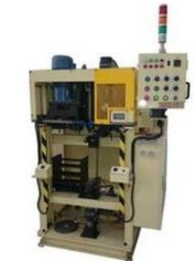
Final Caulking M/C 管密封機
