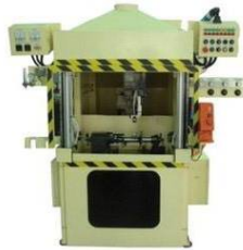
Robot Welding M/C 機械手臂焊接機
